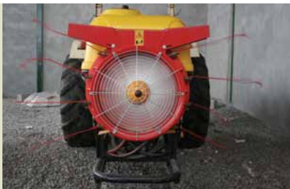
Figura 11 – Regulação do ventilador e orientação dos deflectores e bicos
