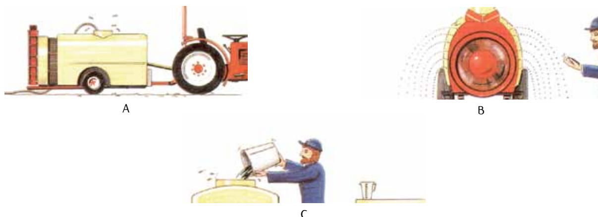
Figura 15 – Débito do pulverizador por reabastecimento. (A) - enchimento inicial; (B) - durante 1 minuto, pulverizar com os bicos seleccionados à pressão escolhida; (C) - reabastecimento com medição (l/min) (Adaptado de Caliset®. marca registada Syngenta AG, Suíça)
