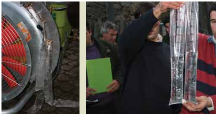
Figura 7 a – A medição do débito de cada bico durante 1 minuto, um deles com ponta nova (apuram-se os valores médios de um mínimo de duas leituras). Figura 7 b – Comparação do débito medido por bico
