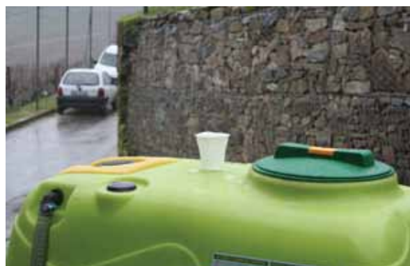
Figura 6 – Método expedito de avaliar o desequilíbrio da turbina
