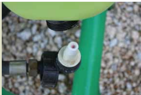
Figura 2 – Bico do agitador desmontado para limpeza
