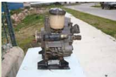
Figura 3 b – Reservatório do óleo da bomba com mistura de água da calda
