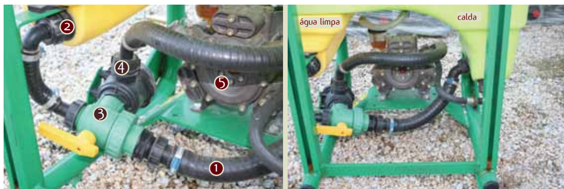
Figuras 8 e 9 – Sistema de limpeza do circuito hidráulico (1. entrada de calda; 2. entrada de água limpa; 3. válvula de três vias; 4. filtro e tubo de aspiração; 5. bomba). Conforme a posição da válvula teremos: trajecto da calda em pulverização (1-3-4-5); trajecto de limpeza (2-3-4-5)
