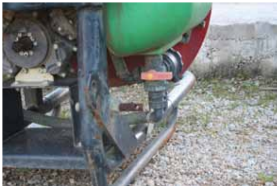
Figura 1 – Pormenor de corrosão no “chassis”
