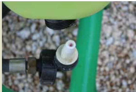
Figura 2 – Bico do agitador desmontado para limpeza
